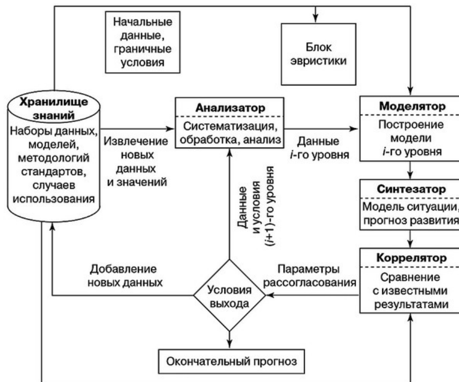
Рис. 30 - Схема интеллектуальной самообучающейся подсистемы
