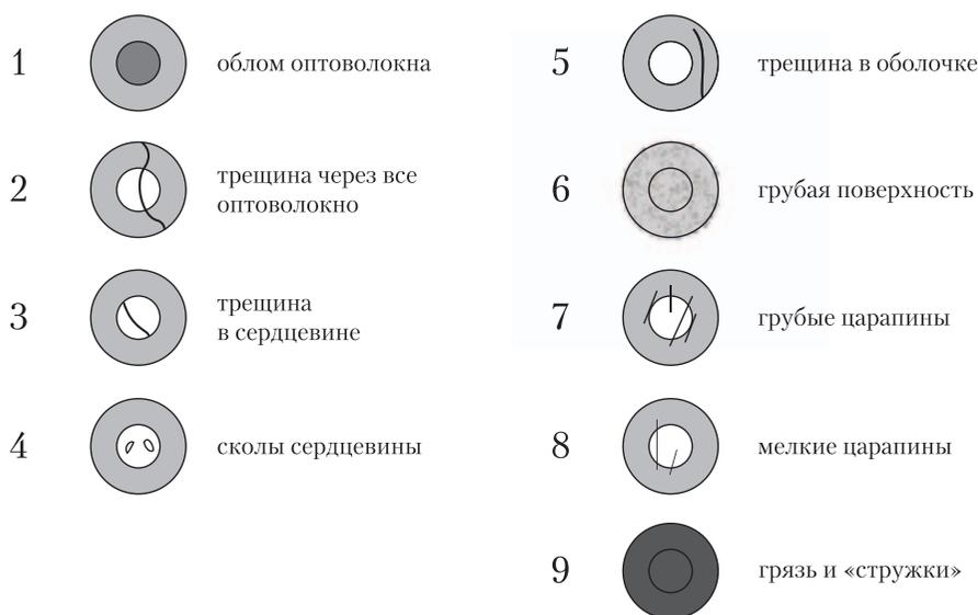
Рис. 10.1. Виды брака при обработке торца наконечника коннектора
