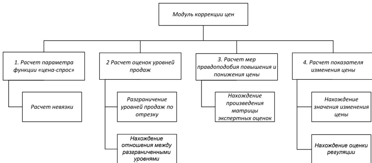
Рисунок 6.6 – Структура модуля коррекции цен
