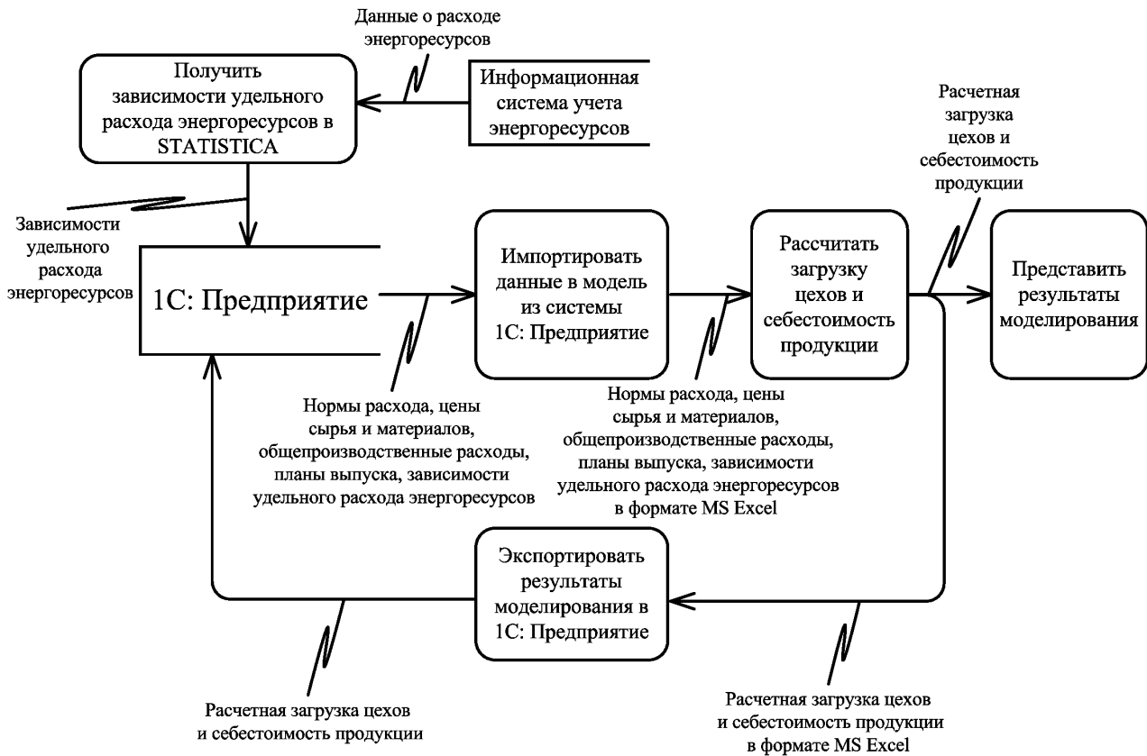
Рисунок 6.8 – Схема автоматизированной технологии обработки информации
