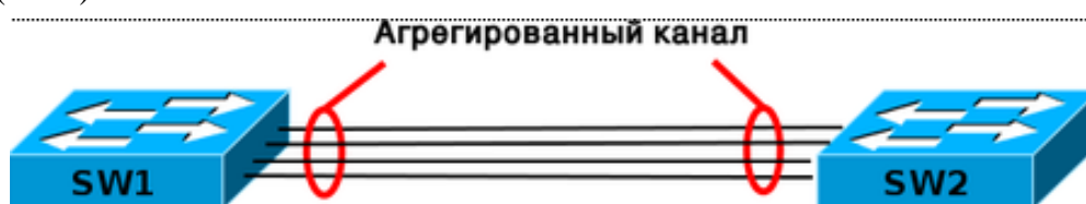
Рис 3.15. Агрегированные линии (link aggregation) и порты Port Trunking.
