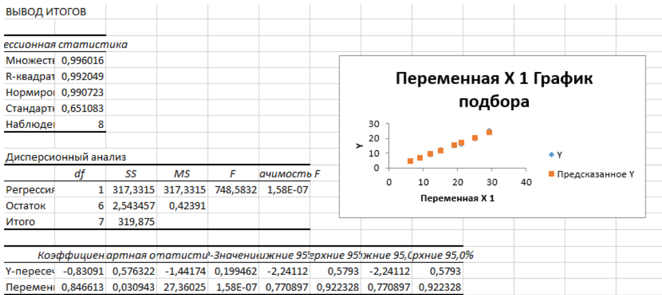
Рисунок 9 – Результаты анализа и график соответствия экспериментальных точек и предсказанных по регрессионной модели
