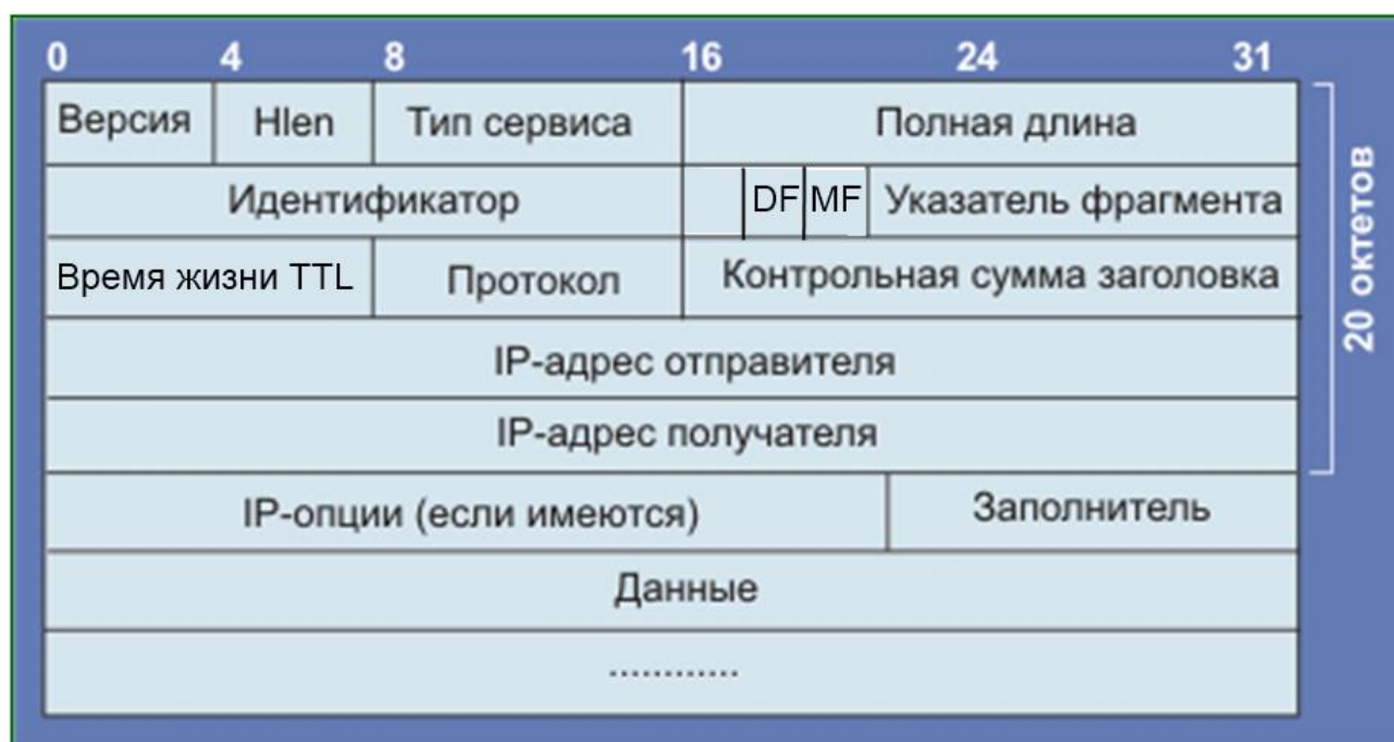
Рисунок 7.1 Структура заголовка IP-пакета версии v4.
